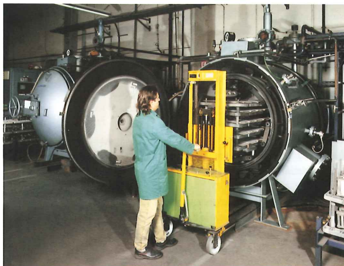
Beschickung einer modernen Vakuum Härteanlage, Fa. Sträter 1992. Charging of a modern vacuum hardening plant, Messrs. Sträter 1992.
