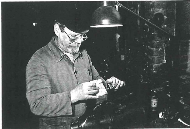
links: Werkzeugmacher bei der Bearbeitung eines Gesenkwerkzeuges am Schraubstock
