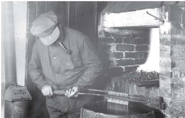
(12) Scherenhärter beim Abschrecken der erhitzten Scherenrohlinge, o.J., um 1910.
