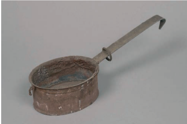
Leimtopf - am Stiel befindet sich ein aus einer Scherezange gefertigter Ring, mit dessen Hilfe der Pinselstiel fixiert werden konnte.
