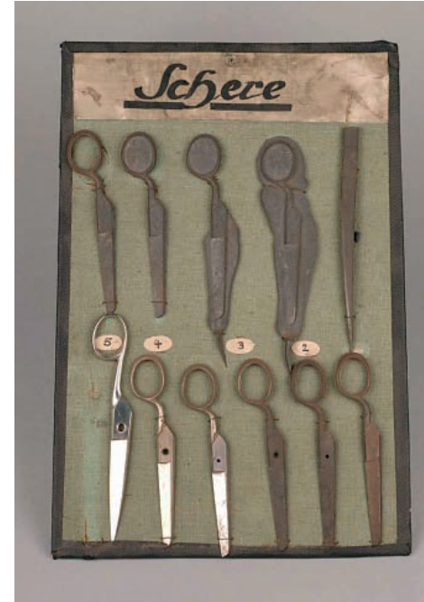
Werdegang einer im Gesenkschmiedeverfahren hergestellten Schere. Aus der Sammlung der Fachschule für Metallgestaltung
