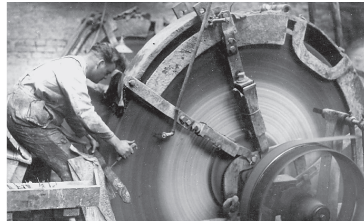
(13) Schleifer in halb gebückter Haltung beim Nassschliff am großen Stein.
