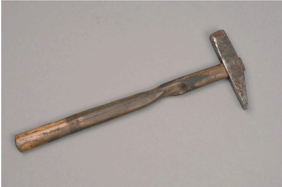
Hammer eines Scherenmonteurs - mit starken Gebrauchsspuren Hammer of a scissors fitter – with signs of heavy use Marteau d'un monteur de ciseaux – avec de fortes traces d'usage/utilisation Martell d'un muntador de tisores amb senyals impreses per la utilització
