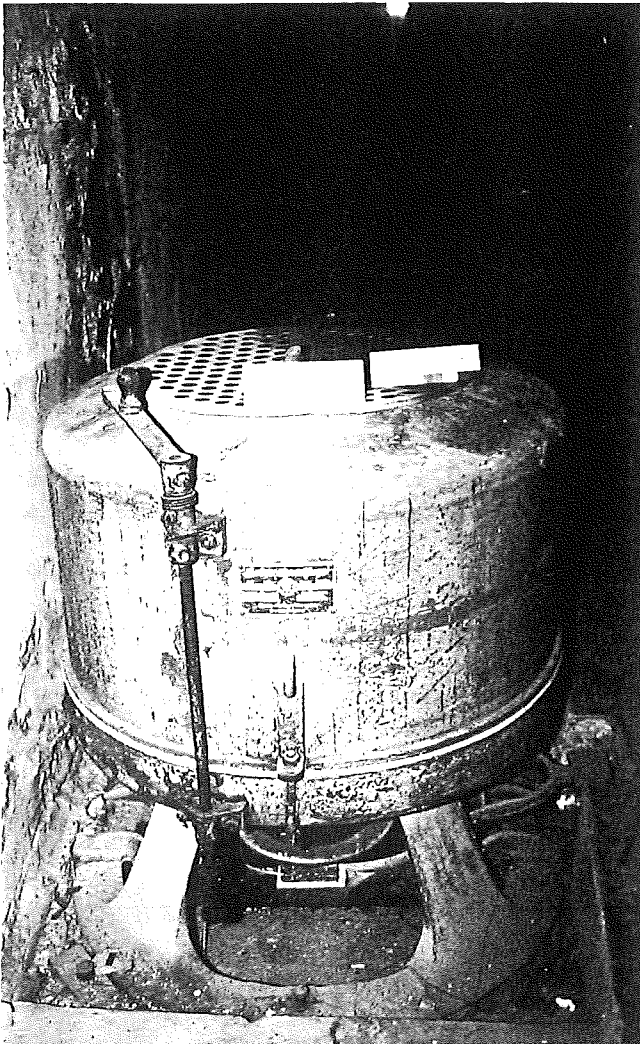
Abb. 7. Die Wollschleuder im Vorzustand. Sie sollte gemäß dem Restaurierungsziel „Zustand 1961“ restauriert werden.
