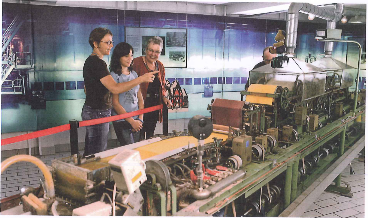
4 Laborpapiermaschine aus dem Jahr 1957. Die Maschine wird mehrmals täglich in Betrieb gesetzt. Im Hintergrund ein Großdia, das eine moderne Papiermaschine zeigt, 2008.
